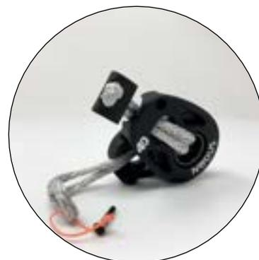
Poulie ouvrante **PO®**, fournie avec une Manille T en Dyneema® Ultra légère, de forme compacte elles sont conçues pour une charge de travail élevée. Les charges sont conduites directement des réas au point d'attache permettant des joues pivotantes latérales légères. Conçus principalement pour la course, ils peuvent être utilisés dans presque toutes les situations possibles..
