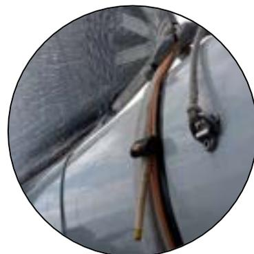
**S T-close®**, est une sangle "cravate" permettant de fixer le point d'écoute d'une GV à bordure libre sur la bôme.
