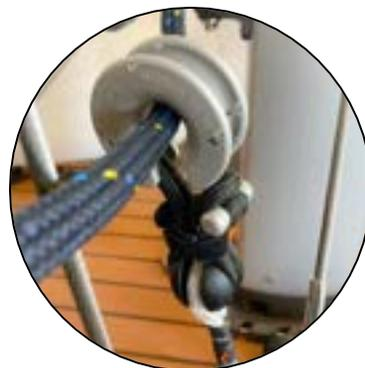
**Textile-Hook HK®** en duralumin est la solution de contrôle d'écoute la plus légère et la plus résistante du marché,
