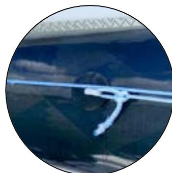
Pontet textile en résine à coller, le Pad-SX® est un padeye à coller conçu et développé par Nodus Factory, pour répondre à des besoins spécifiques à bord.
