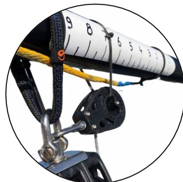
**SC®**, est une sangle "cravate" permettant de fixer le point d'écoute d'une GV à bordure libre sur la bôme.
