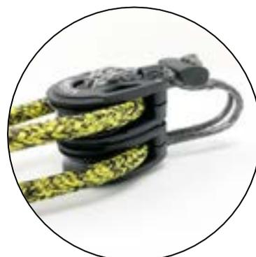
**Poulie double Hi-Tech P2® Nodus®**, Poulie double à transfilage Hi-tech haute résistance et ultra légère, de forme compacte elles sont conçues pour une charge de travail élevée. Les charges sont conduites directement des réas au point d'attache permettant des plaques latérales légères. Conçus principalement pour la course, ils peuvent être utilisés dans presque toutes les situations possibles..
