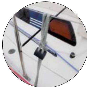
**T-bat®**, dispositif textile permettant de régler et d'accrocher rapidement vos pare-battages et défenses sur filière.
