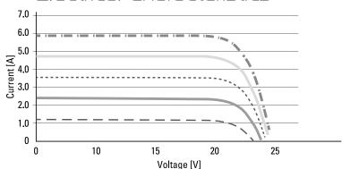
100 W/m<sup>2</sup> 600 W/m<sup>2</sup> 200 W/m<sup>2</sup> 800 W/m<sup>2</sup> 400 W/m<sup>2</sup> 1000 W/m<sup>2</sup>
