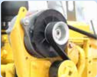
12 volt 120 amp alternator
