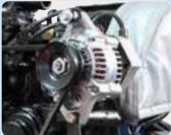
12 volt 50 amp alternator
