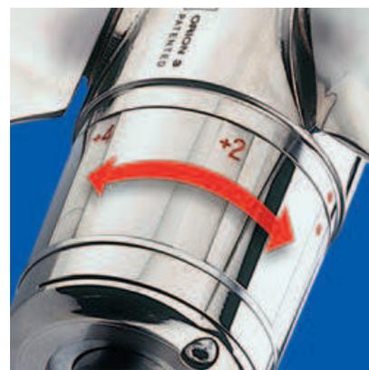
Un dispositivo brevettato consente di effettuare l'impostazione micrometrica del passo dall'esterno con un campo di regolazione di angoli tra 14° e 26°
