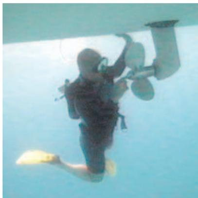
**E<sup>3</sup>** è stata progettata per essere installata e rimossa facilmente, rimanendo completamente assemblata
