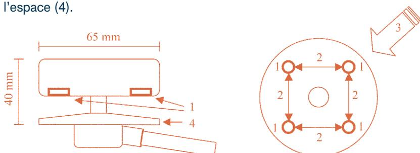
Dans la gamme CV7, les transducteurs communiquent latéralement ce qui procure quatre mesures indépendantes. Les contrôles de validité s'en trouvent renforcés et les vecteurs mesurés au vent de front sont privilégiés pour établir vitesse et direction.
