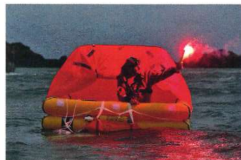
Le feu à main doit être tenu sous le vent pour éviter les risques de brûlure.
