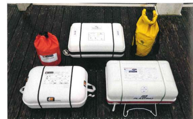
Le conteneur du radeau For Water (à gauche) est bien plus compact que les autres. Et comme celui de Plastimo, il est doté de poignées pour le portage. Très utile!
